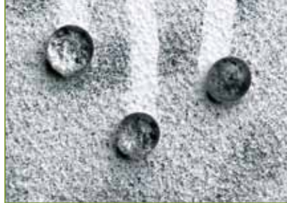
Lotus-Effekt®-Farbe an der Hauswand: Das Wasser nimmt den Schmutz mit
