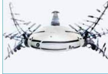
Der Aqua_ray ohne Haut – deutlich zu sehen: die grätenartigen Fin Ray®-Flossen
