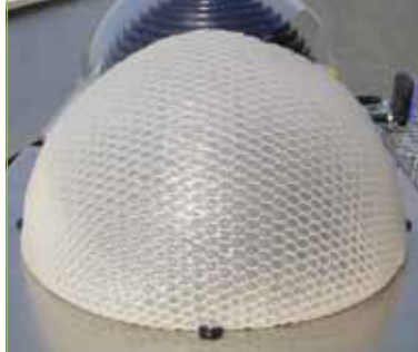
Mit dem neuartigen Dämmstoff isolierter Kugel Sonnenkollektor
